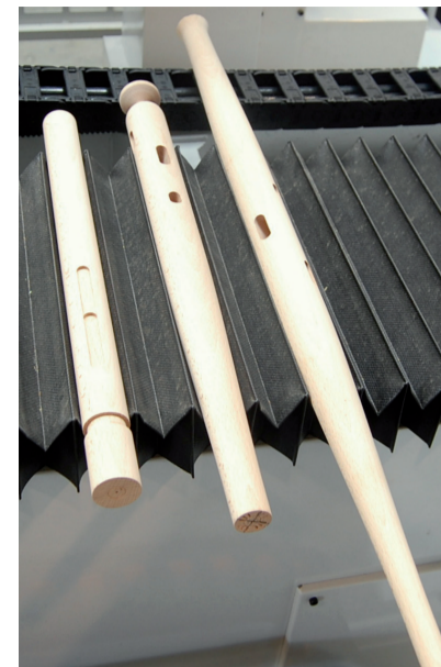
Przez frezowanie na CKX-1600 BT należy rozumieć nie tylko wykonywanie otworów, ale też różnych kształtów na powierzchni galanterii drewnianej.
