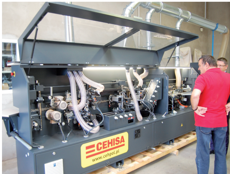
Zainteresowanie budziła okleiniarka Xpert, wyposażona w 11 serwowmotorów.
